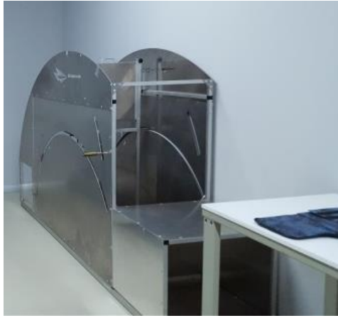
ARMOUR DROP TEST (NIJ 0101.06)
