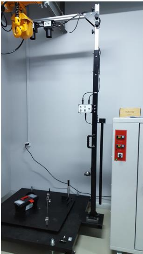
Drop test rig (NIJ)
